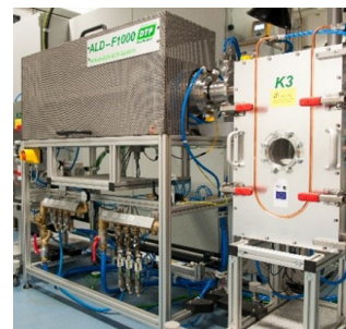
Laborbeschichtungsanlage (CVD, ALD) für Batch- und Rolle-zu-Rolle-Betrieb.
